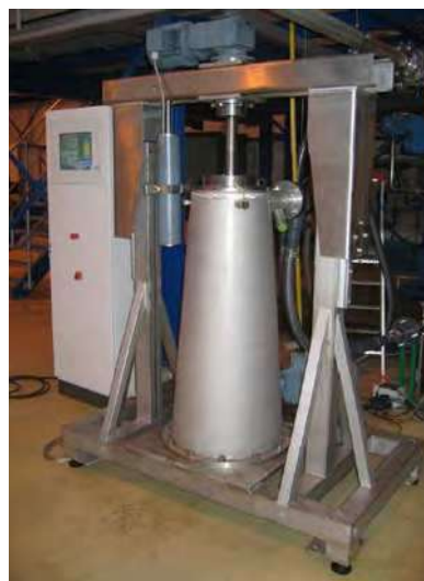
FlocFormer 3L en fonctionnement
